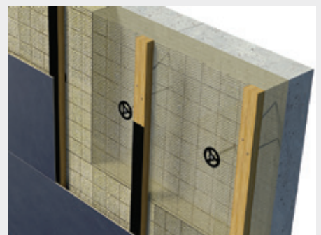
Thermisch geoptimaliseerde bevestigingswijze met afstandschroeven
