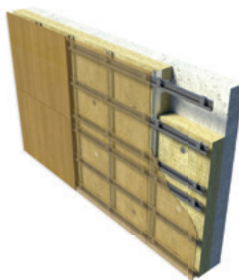
Fixation mécanique aveugle sur une ossature en aluminium ou en acier
